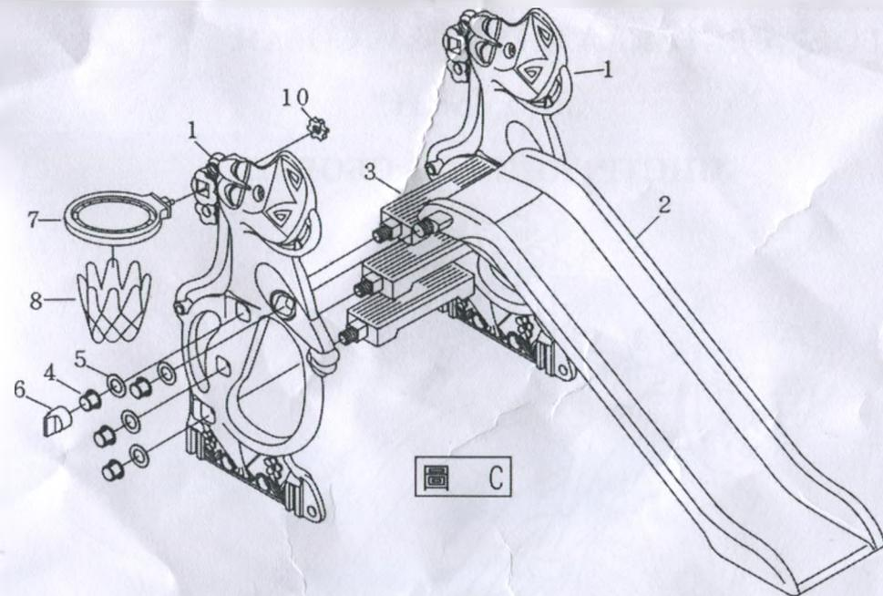
3. Вторую опорную боковину (1) вставьте соответствующими отверстиями в три ступеньки (3) и горку (2), наденьте на резьбу зеленые шайбы (5) и закрутите желтые гайки (4) при помощи белого ключа (6) для фиксации конструкции. Вставьте корзину (7) в квадратное отверстие, расположенное в верхней части опорной боковины (1) и закрепите ее при помощи гайки (10), затем навесьте на нее сетку (8). (Рисунок С)
