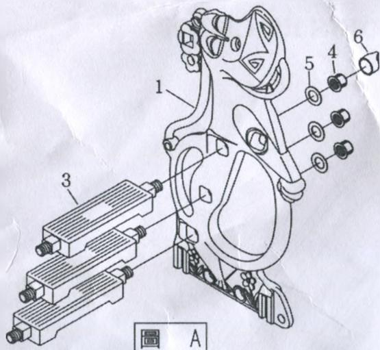
1. Поставьте опорную боковину (1) вертикально и вставьте все три ступеньки (3) в соответствующие отверстия боковины (1). Вставьте зеленые шайбы (5) и закрутите желтые гайки (4) при помощи белого ключа (6) до упора для фиксации конструкции. (Рисунок А)
