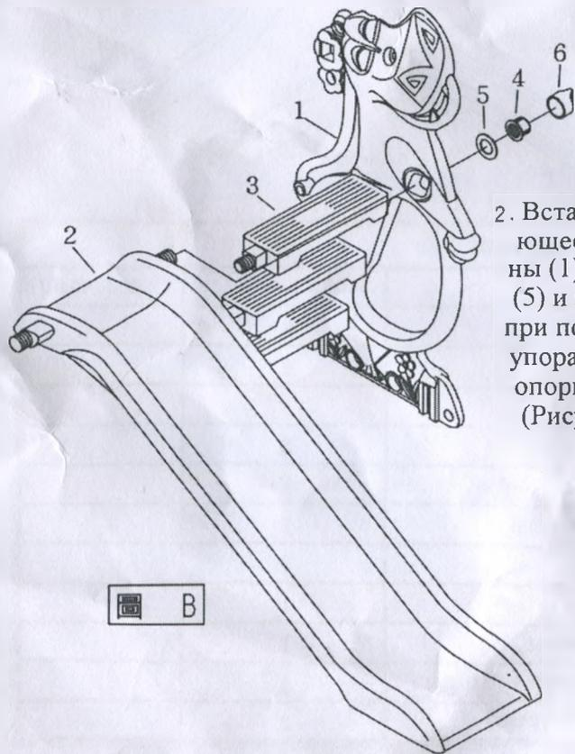
2. Вставьте горку (2) в соответствующее отверстие опорной боковины (1). Наденьте зеленую шайбу (5) и закрутите желтую гайку (4) при помощи белого ключа (6) до упора для фиксации горки на опорной боковине. (Рисунок В)
